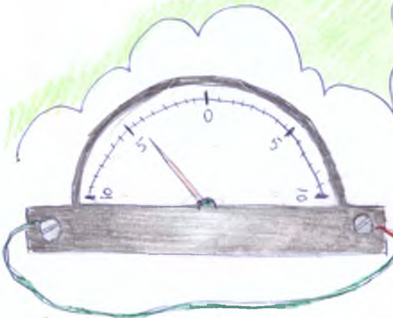
ФОТОЭФФЕКТ - ОСВЕЩЕНИЕ СЕЛЕНА (ОКСИДА МЕДИ (I), КРЕМНИЯ) ПРОИСХОДИТ ПОТЕРЯ ОТРИЦАТЕЛЬНОГО ЭЛЕКТРИЧЕСКОГО ЗАРЯДА
